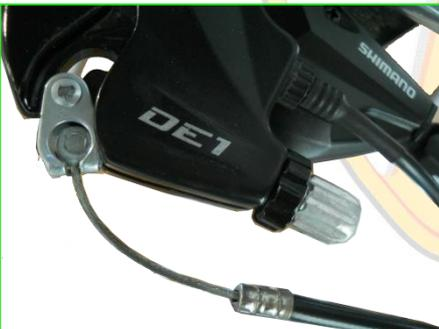
1. Si necesita retirar el cable de freno, debe hacerlo tal como se indica en la imagen e referencia.
