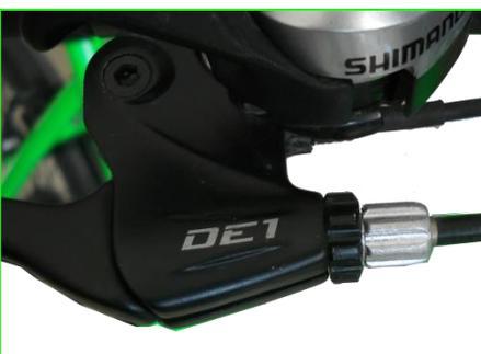
1. La tuerca y contratuerca que se encuentra en las manijas de freno sirve para realizar el ajuste fino del largo de freno, y es una manera rápida y simple de regularlos y evitar recurrir al uso de herramientas.
