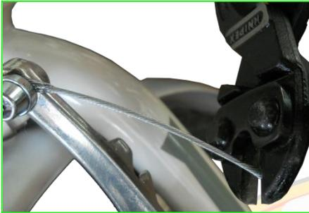
1. Corta el excedente del cable trenzado de freno para que no pueda ocasionar problemas.
