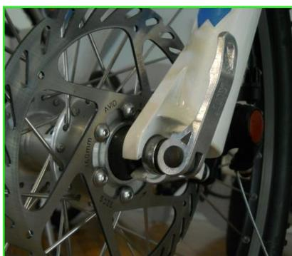
1. Eje de rueda con ajuste rápido.
