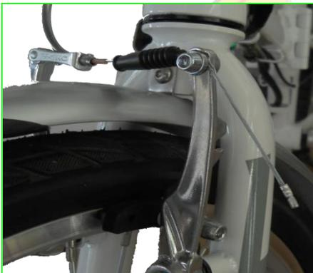
2. Utilice un terminal para recubrir el extremo del cable y evitar así que se deshilach, lo cual puede resultar peligroso.
